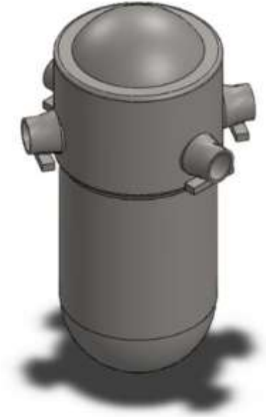
Şekil 2. Reaktör kabının montajlı katı modeli
