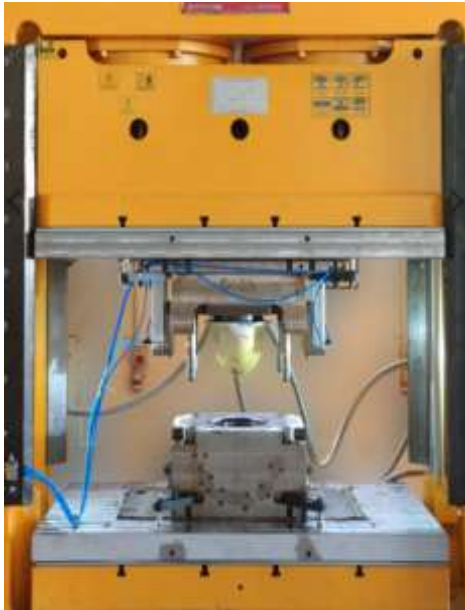
Şekil 5. Balistik Zırh Malzemesi Üretiminde Kullanılan Bir Hidrolik Pres Makinesi (Özkoç Hidrolik Makine, 2024).
