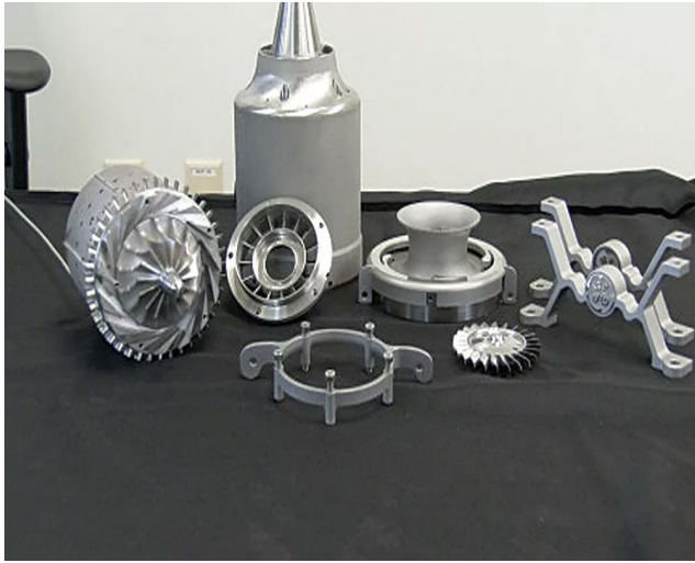
Şekil 1. GE Motor tarafından üretilen bazı eklemeli imalat metal motor parçaları (solda)(GE Motor izniyle), A320 neo Geared Turbofan™ motor için boroskop başlığı (sağda) (MTU Aero Engines izniyle).
