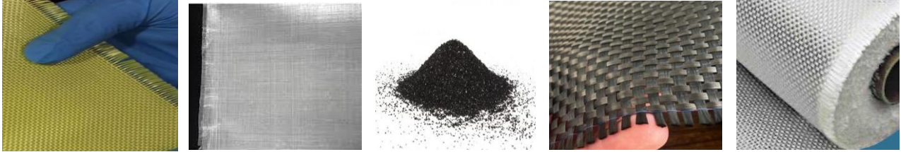
(a) Aramid Kumaş (b) Uhmwpe (c) Seramik (d) Karbon (e) Cam Lifi
